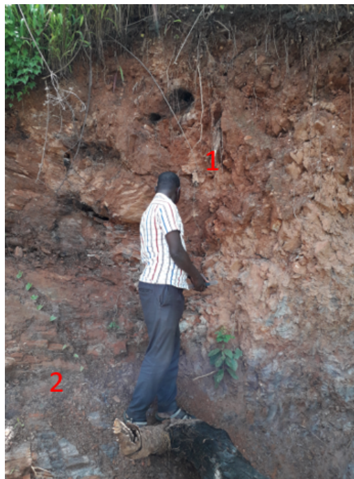
Photo 2 : Excavation montrant les altérites (1) sur micaschistes altérés (2)
